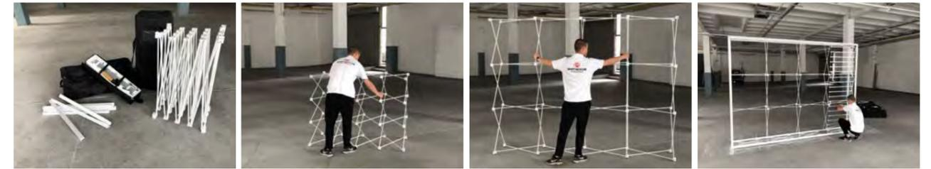
Das GRID-Grundsystem ist in wenigen Sekunden aufgebaut. Das System ist klein verpackt (30x30x80 cm) und hat nur ein Gewicht von 11 kg.
