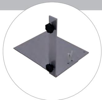
Stahl, grau, RAL 7015 für freistehende OCTAWall 60 Rahmenelemente aus Profil W 820, W 825 und W 830 **zur seitlichen Montage** und zusätzlichen Befestigung an das untere Profil, inkl. Befestigungszubehör M 1951 BS (M8), **Fußüberstand nach einer Seite**, für Aufbau vor Wand, verwendbar für rechte Seite und linke Seite **max. Rahmenbauhöhe = 2500 mm** 5,313 kg
