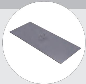
Stahl, grau, RAL 7015 für freistehende OCTAWall 60 Rahmenelemente aus Profil W 820, W 825 und W 830 **als zusätzlicher Mittelfuß** zur Montage und Befestigung an das untere Profil, inkl. Befestigungszubehör M 1953 BS (M8) **Achtung:** nur in Verbindung mit M 1951 verwendbar **max. Rahmenbauhöhe = 2500 mm** 6,686 kg
