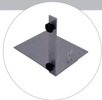
Stahl, grau, RAL 7015 für freistehende OCTAWall 40 Rahmenelemente aus Profil M 1307 und W 907 **zur seitlichen Montage** und zusätzlichen Befestigung an das untere Profil, inkl. Befestigungszubehör M 1951 BS (M8) **Fussüberstand nach einer Seite**, für Aufbau vor Wand, verwendbar für rechte Seite und linke Seite **max. Rahmenbauhöhe = 2500 mm**
