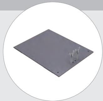
Stahl, grau, RAL 7015 für freistehende OCTAWall 40 Rahmenelemente aus Profil M 1307 und W 907, **als zusätzlicher Mittelfuß** zur Montage und Befestigung an das untere Profil, inkl. 2 x Befestigungszubehör M 1953 BS (M8), **Fussüberstand nach einer Seite**, für Aufbau vor Wand **Achtung:** nur in Verbindung mit M 1961 verwendbar **max. Rahmenbauhöhe = 2500 mm**
