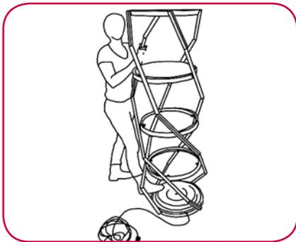
Säule bis zum Ende aufziehen, dabei den Fuß weiter zur Stabilisierung des Bodens verwenden.
