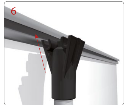
Das Endstück in die Klemmleiste stecken.
